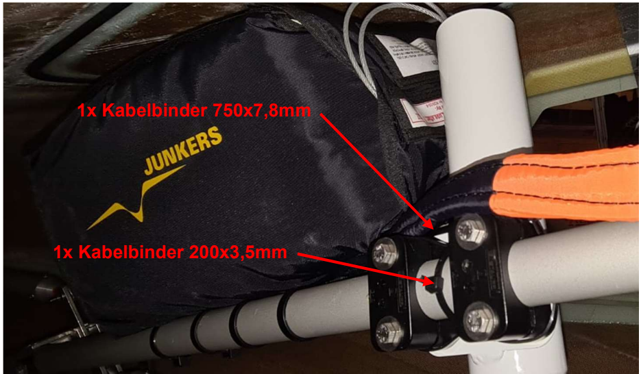
Abbildung 14: Befestigungspunkte Kabelbinder Junkers LSSP
